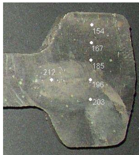
Рис.6 – Значение твердости в ободе отливки (НВ)
