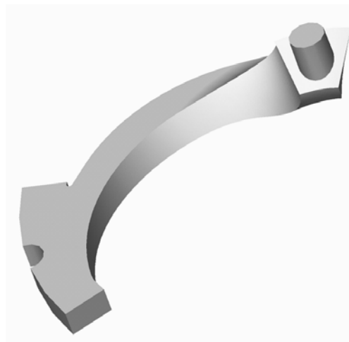
Рис. 2. Объемная модель стержня для отливки «Рабочее колесо».
