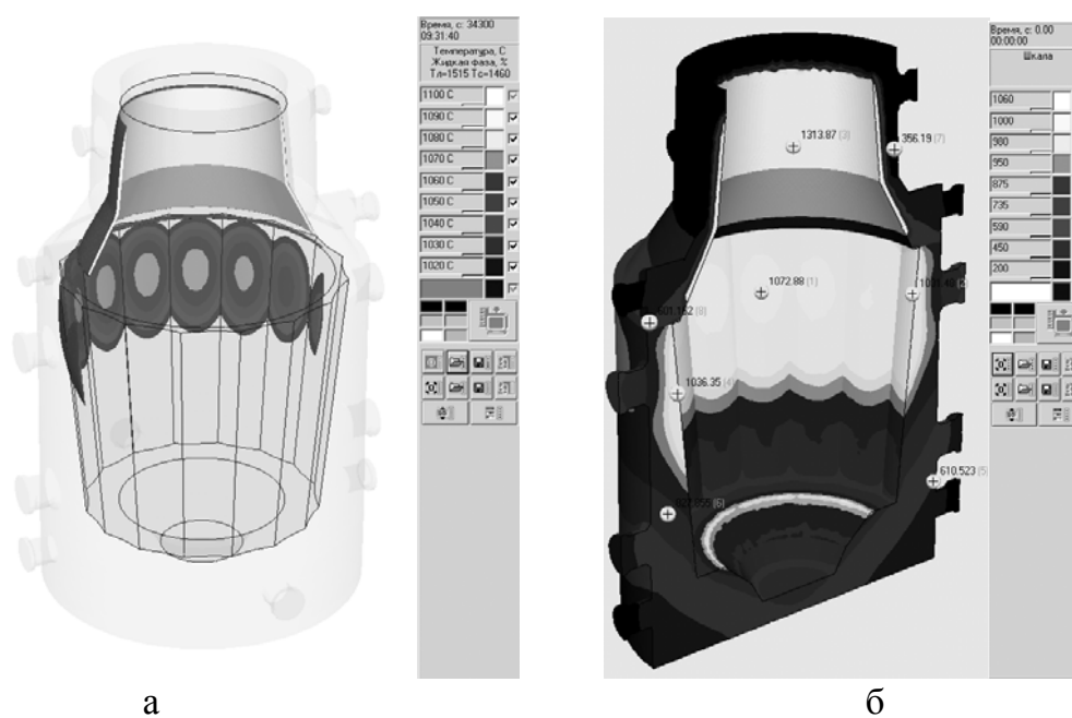
Рис. 6. Разгар стенок изложницы
