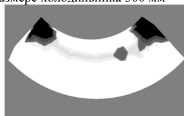
пористости в отливке при засыпке утепляющего слоя
