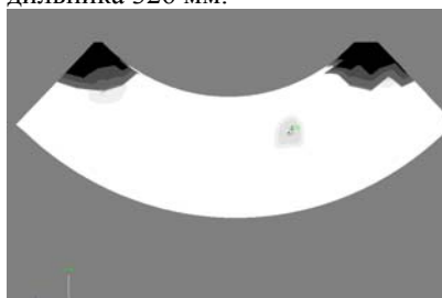
пористость при оптимальном размере холодильника 300 мм
