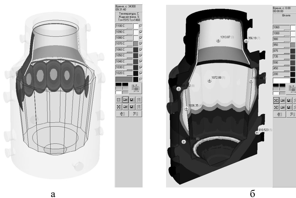
Рис. 6. Разгар стенок изложницы
