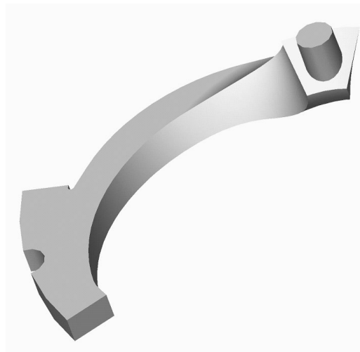
Рис. 2. Объемная модель стержня для отливки «Рабочее колесо».
