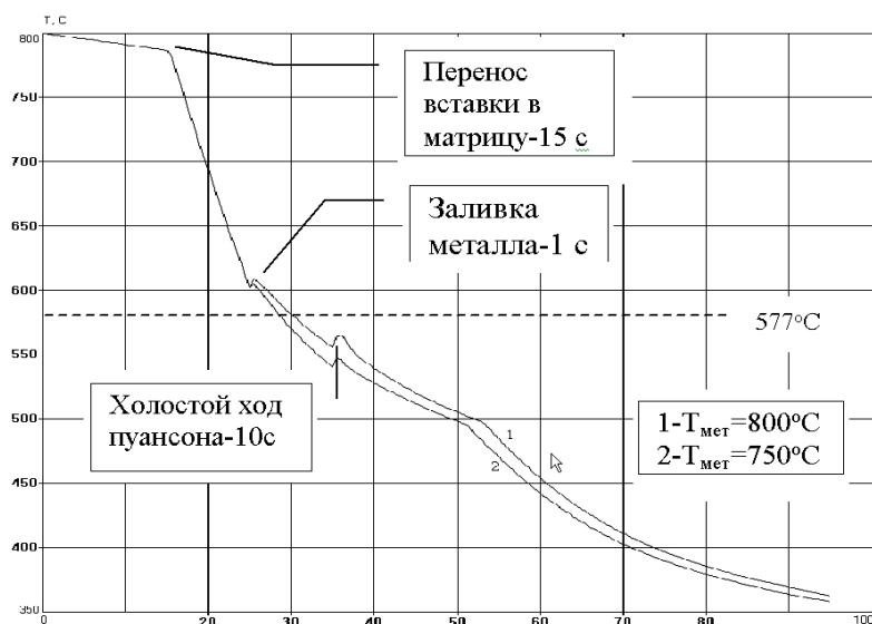
Рис. 4. Температурно-временной режим процесса литья с кристаллизацией под давлением (компьютерное моделирование).
