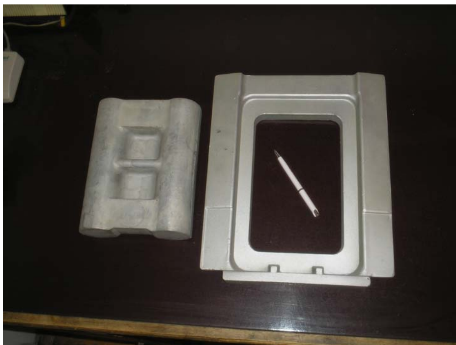
Фото 1. Отливки, изготовленные способом литья с кристаллизацией под давлением. Слева – сплав ВАЛ10 (Al-Cu), справа – сплав АЛ23-3 (Al-Mg-Li)
