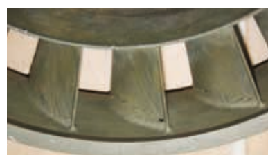
Трещины в отливке (АО «ОДК» – «Салют»)
