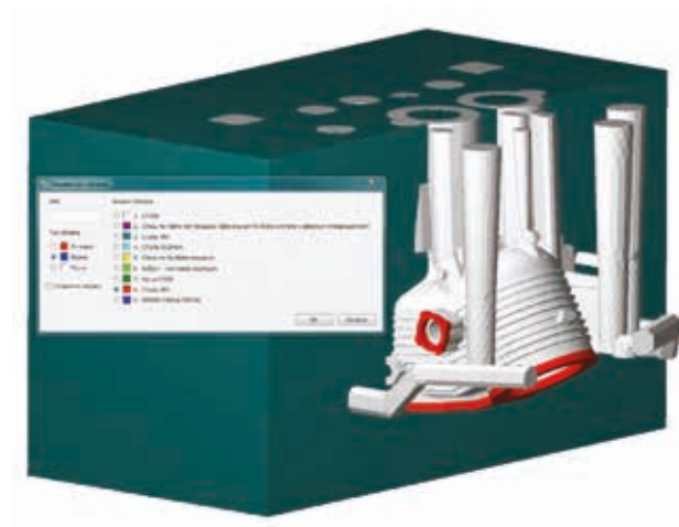
Модель отливки «Корпус» с холодильниками и формой, подготовленная к расчету (ОАО «ААК "Прогресс" им. Н.И. Сазыкина)
