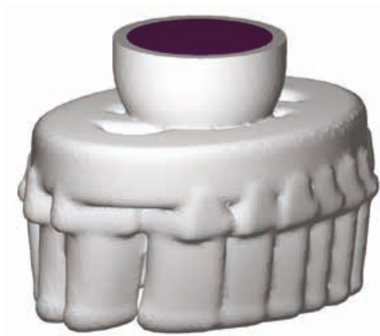
Керамическая форма, автоматически созданная в препроцессоре POLIGONSOFT (ООО «СКБТ»)
