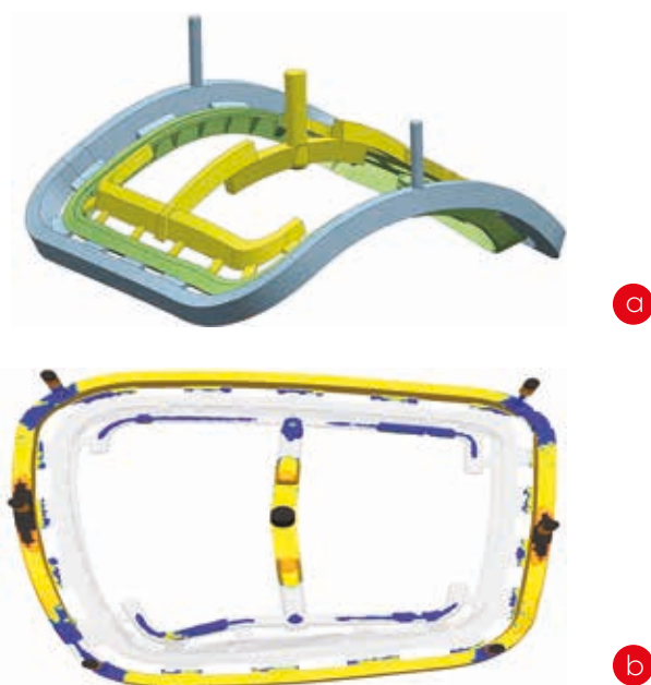
Рис 2. Новая конструкция ЛПС для отливки типа «Рама»: а) 3D-модель литейного блока б) результат прогноза пористости
