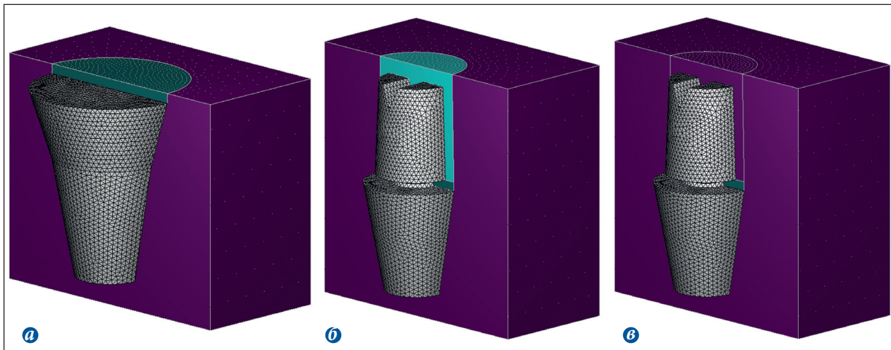
Рис. 2. Конечно-элементные модели слитка в форме с прибылями разной конструкции: а — традиционного типа; б — легкоотделяемая в экзотермической оболочке; в — легкоотделяемая, без обогрева
