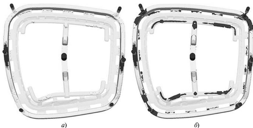
Рис. 5. Поля усадочной пористости >1\% (а) и >0,2\% (б) в отливке, полученной по предлагаемой технологии, рассчитанные в СКМ ЛП "ПолигонСофт"
