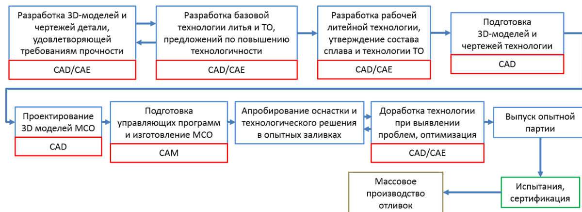
Рис. 1. Сквозное проектирование при подготовке и запуске производства отливок (упрощённая схема)
