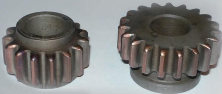
Рис. 1. Зубчатая пара заднего хода легкового автомобиля ВАЗ 2107 с Cu-покрытием (поверх диффузионного)
