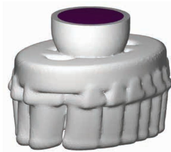
Керамическая форма, автоматически созданная в препроцессоре «ПолигонСофт» (ООО «СКБТ»)
