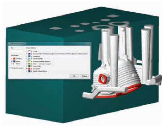
Модель отливки «Корпус» с холодильниками и кокилем, подготовленная к расчету (ОАО «ААК «Прогресс» им. Н.И. Сазыкина)
