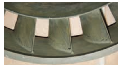
Трещины в отливке (АО «ОДК» – «Салют»)
